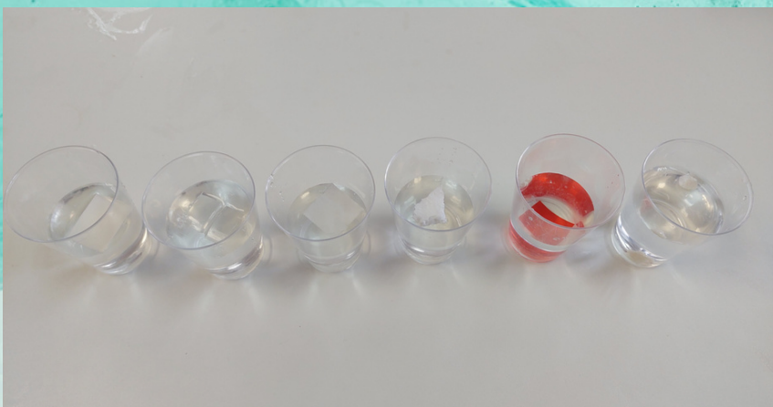
Slika 6. Ispitivanje gustoće uzoraka plastike u odnosu na gustoću vode
