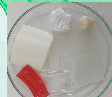
Slika 4. Različiti uzorci plastike u acetonu
